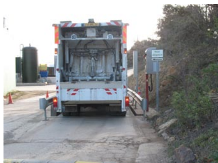
Pont bascule pour la pesée des déchets
